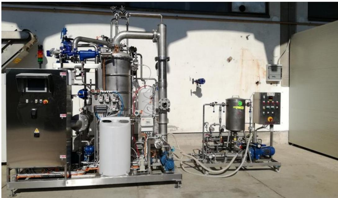
Nel digestato suino di partenza è stata riscontrata la presenza consistente di sostanze inerti come sabbia (provenienti dal fondo del digestore) che hanno comportato la sostituzione di alcune membrane del
